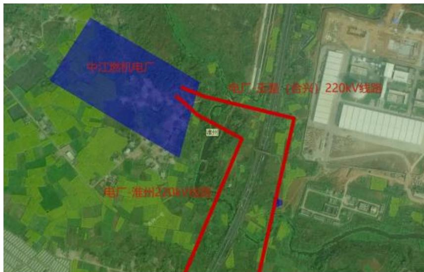
图 2.1-2 中江燃气电厂出线示意图
